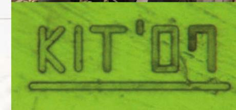
直径8ミクロンのドリルで真ちゅう板に彫り込まれた、長さ50ミクロン(髪の毛の太さの約半分)の極小文字。少しでも振動を加えるとドリルの刃先が折れてしまうので、慎重に慎重を期さなければならない。
