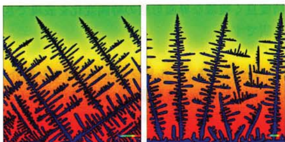
図4 GPU計算によるニッケル合金のデンドライト成長シミュレーション
